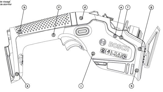
Anzugsmomente Torque values Couple de serrage Pares de apriete 0,6 - 0,9 Nm
